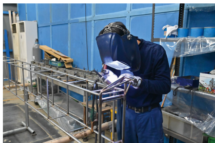
ステンレス製はしごの溶接作業(左)とチタン製はしごを組み立てる様子(右)。 チタン製の3連はしごは長さが約8.7mに達する物もあるが、重量は30kg程度と消防士が一人で持ち運ぶことができる
