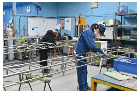
ステンレス製はしごの溶接作業(左)とチタン製はしごを組み立てる様子(右)。 チタン製の3連はしごは長さが約8.7mに達する物もあるが、重量は30kg程度と消防士が一人で持ち運ぶことができる
