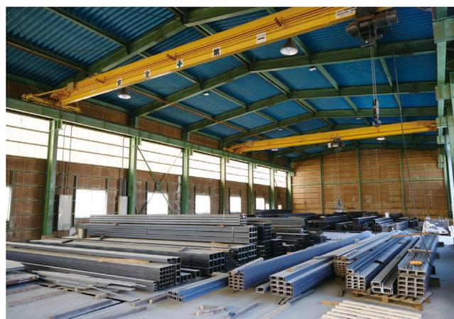
顧客の要望に合わせて迅速に出荷できるよう、倉庫には鋼材を運搬するためのホイストクレーンが9基設置されている
