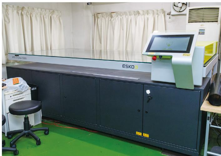
日版グループが日本で初めて導入したというドイツ製の「ESKO XPS Crystal 5080」。製版の一工程である露光を担う装置で、UV LED露光により安定して高品質の製版ができる
