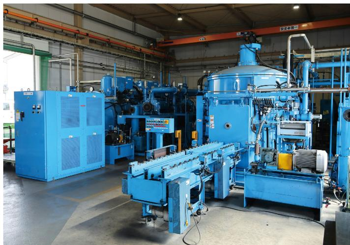
「真空焼き入れ」を行う真空炉。焼き入れ後の金属は硬くなるが、そのままではもろくて割れやすいため、「焼き戻し」をして最適な硬度に調整する
