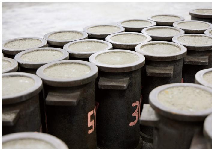
建設現場から採取した生コンクリートを詰めた「テストピース」でコンクリートの圧縮強度試験を行う
