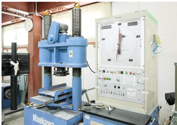
本社の構造材料試験所に設置されている、コンクリートの圧縮強度試験の機器
