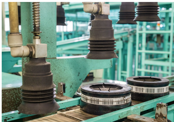
JAつがる弘前の選果機。フリートレイ（バーコード付きの皿）に1個ずつ乗せられたりんごは、機械によって選果される。その後、等級ごとにまとめられたりんごは、自動箱詰機で箱詰めされたのち、全国に出荷されていく
