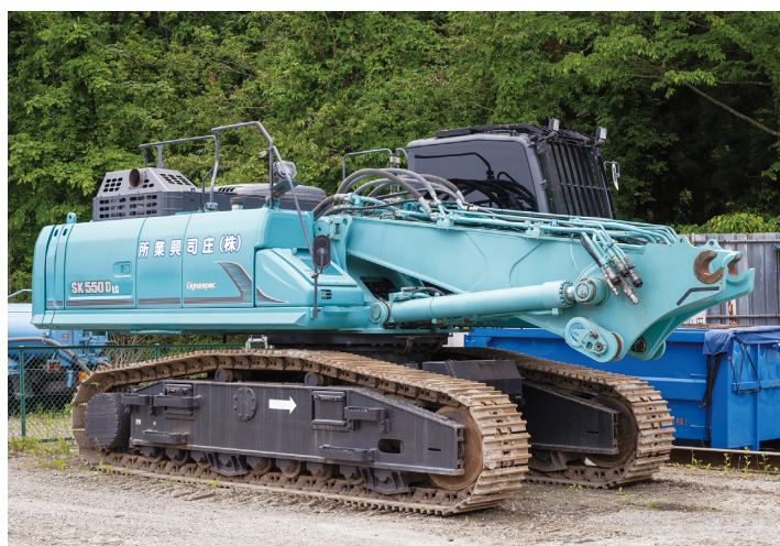
庄司興業所が所有する高層部の解体が可能な「コベルコ建機SK550」のボディ部分。アーム部分と組み合わせて使用する。青森県で唯一の同機の操作には、技術力が求められ、高所解体において活躍する
