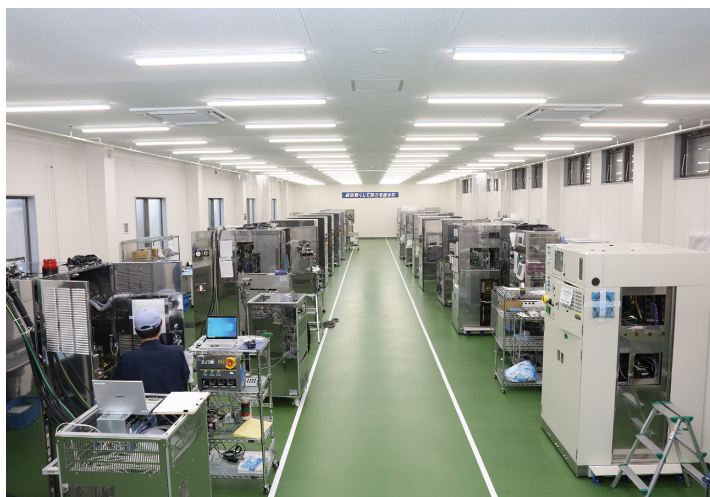
構造が複雑な電力制御装置の組み立ては、手作業で詳細な仕様の調整を行う
